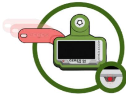
Utilice la Herramienta de Activación y manténgala firmemente apoyada contra el dispositivo durante al menos cinco (5) segundos.
