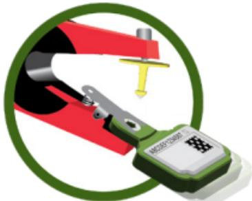
Maintenir la pince métallique enfoncee et insérer le dispositif dans l'applicateur.
